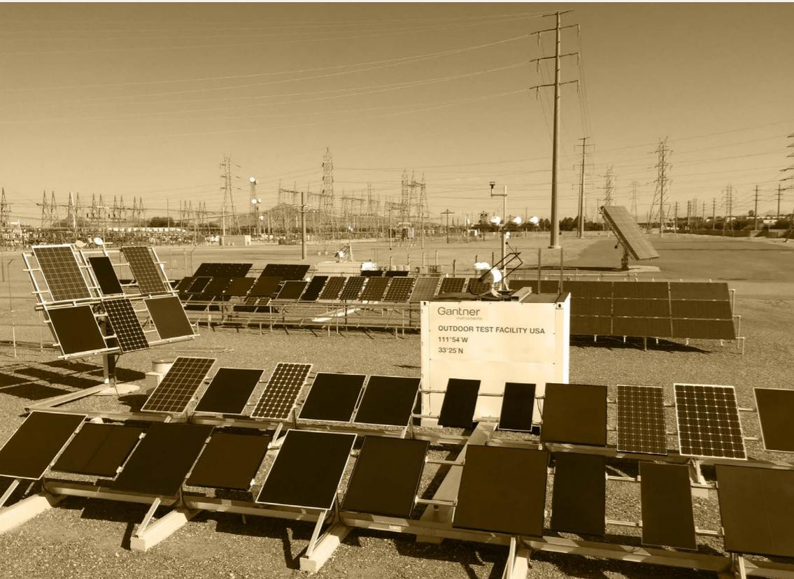
**Zustandsdetektor zur Quantifizierung der Leistung von PV-Kraftwerken auf Tagesbasis im Vergleich zu einem „digitalen Zwilling“ (mechanistisches Leistungsmodell von Gantner). Der Monitor kann häufig auftretende Ausfälle mit einer Genauigkeit von über 98 % erkennen und klassifizieren.**
