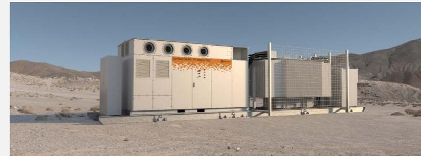
Diese PV-Station besteht aus zwei PV-Wechselrichtern (mit einer maximalen Leistung von 7,5 MW), einem Mittelspannungstransformator sowie dem gesamten erforderlichen Schalt- und Kommunikationszubehör.
