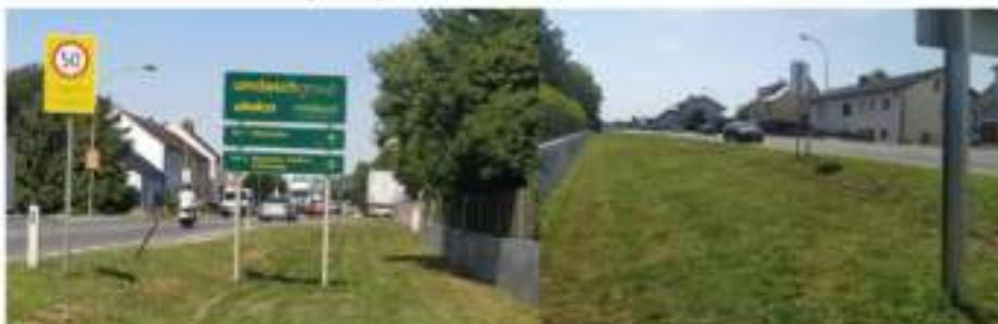
Abbildung 7: Mögliche Maskierung des Verkehrszeichens Geschwindigkeitsbeschränkung durch VIT 2 [Fotos: Snizek + Partner]
