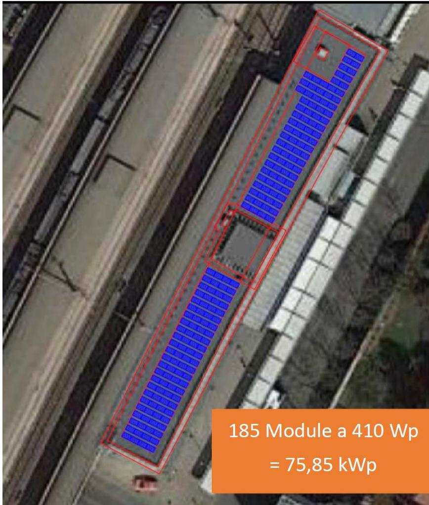
Die Module werden 10° aufgeständert mit einer Südwestausrichtung geplant.
