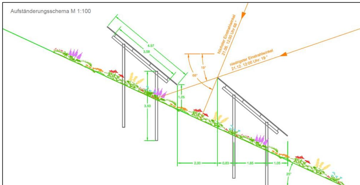
Anordnungsskizze der Photovoltaikmodule Agri-PV-Freiflächenanlage Pians-Grins bei der mittleren Geländeneigung von 25° (Quelle: Ingenieurbüro Trenkwalder)
