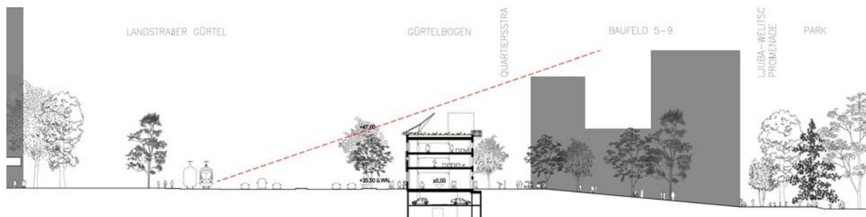
Auf dem 12,5 bzw. 13,5 m hohen Baukörper des Gewerbebaus ist lt. Flächenwidmung eine zusätzliche, 5 m hohe vertikale und transparente Schallschutzwand für die Wohnbauten dahinter an der Dachkante Richtung Gürtel zu errichten. Schallschutzwände im Allgemeinen sind ebenso wie nachträglich auf Dächern angebrachte Solaranlagen aber meist keine Bereicherung der gestalterischen Gebäudekonzeption.
