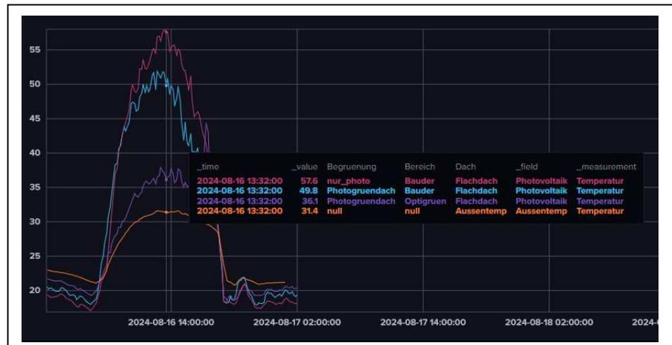
Wochen Trockenheit liegt die PV-Temperatur (allerdings ohne Energieproduktion, da der Wechselrichter noch nicht ans Netz angeschlossen ist) ohne Begrüpfung bei 55°C (Tageshöchsttemp. 32°C), bei den PV-Modulen, unter denen eine Begrüpfung vorhanden ist, bei max. 42°C. Nach nur geringen Niederschlagsereignissen (10mm/m<sup>2</sup>) steigt diese Temperaturdifferenz auf 20°C (thermisches Foto 27).
