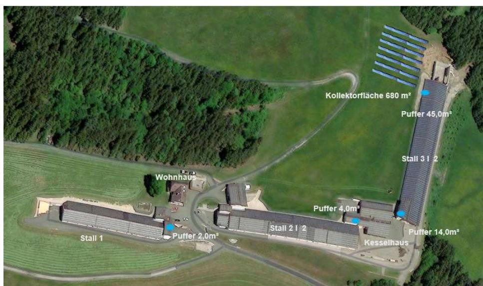
Die Einbindung der 680 m<sup>2</sup> Solarthermie-Anlage erfolgt über den 45 m<sup>3</sup> großen Pufferspeicher im Stall 3. So kann die erzeugte Wärme für den Prozess (wie schon nach dem aktuell ausgeführten Prinzip) auf das Gesamtsystem verteilt werden. Das Gesamtvolumen der Speicherkapazität beträgt somit 65 m<sup>3</sup>.
