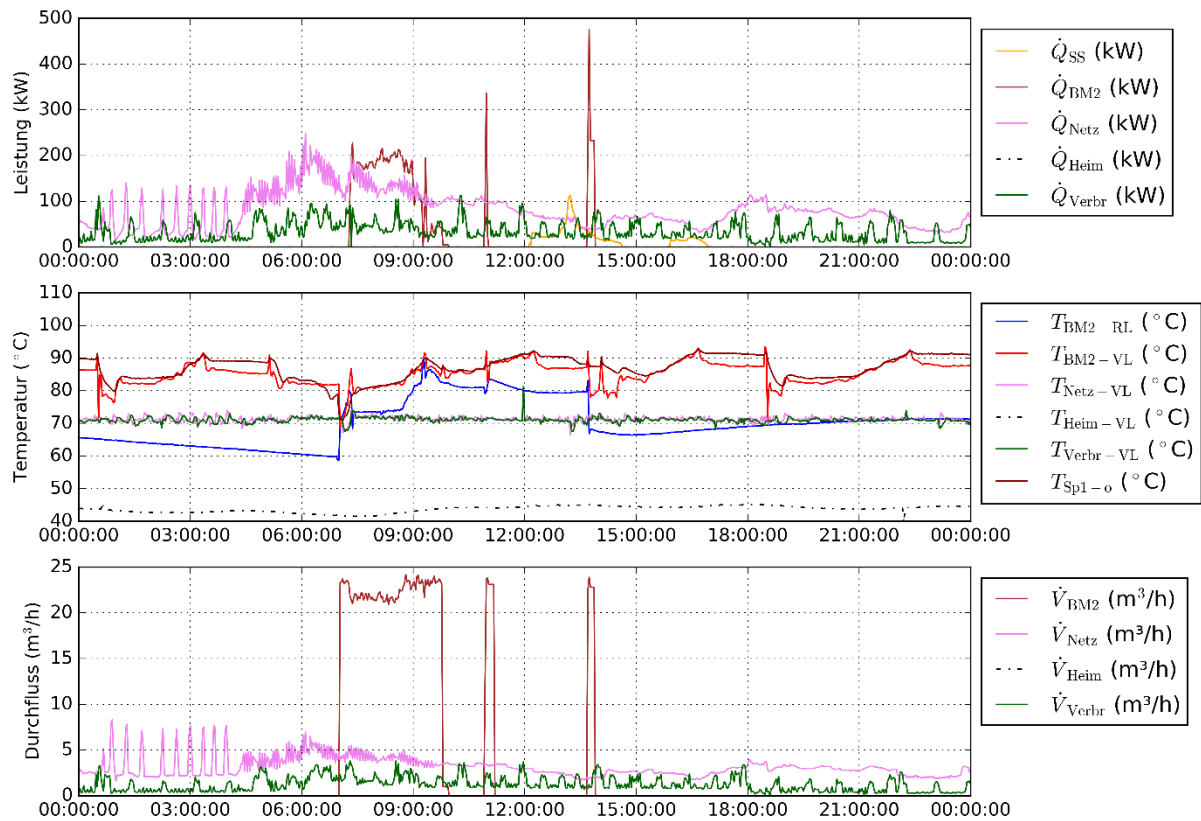
Abbildung 123: Beispielhafte Leistungen (Solarsekundärkreis, Biomassekessel 2, Wärmenetz Nord, Altersheim und Wärmenetz Verbraucher), Vor- und Rücklauftemperaturen Biomassekessel 2, Vorlauftemperaturen (Wärmenetz Nord, Altersheim und Wärmenetz Verbraucher), obere Speichertemperatur des 7 m 3 -Pufferspeicher und Volumenströme (Biomassekessel 2, Wärmenetz Nord, Altersheim und Wärmenetz Verbraucher) (Zeitraum: 22.3.2017)
