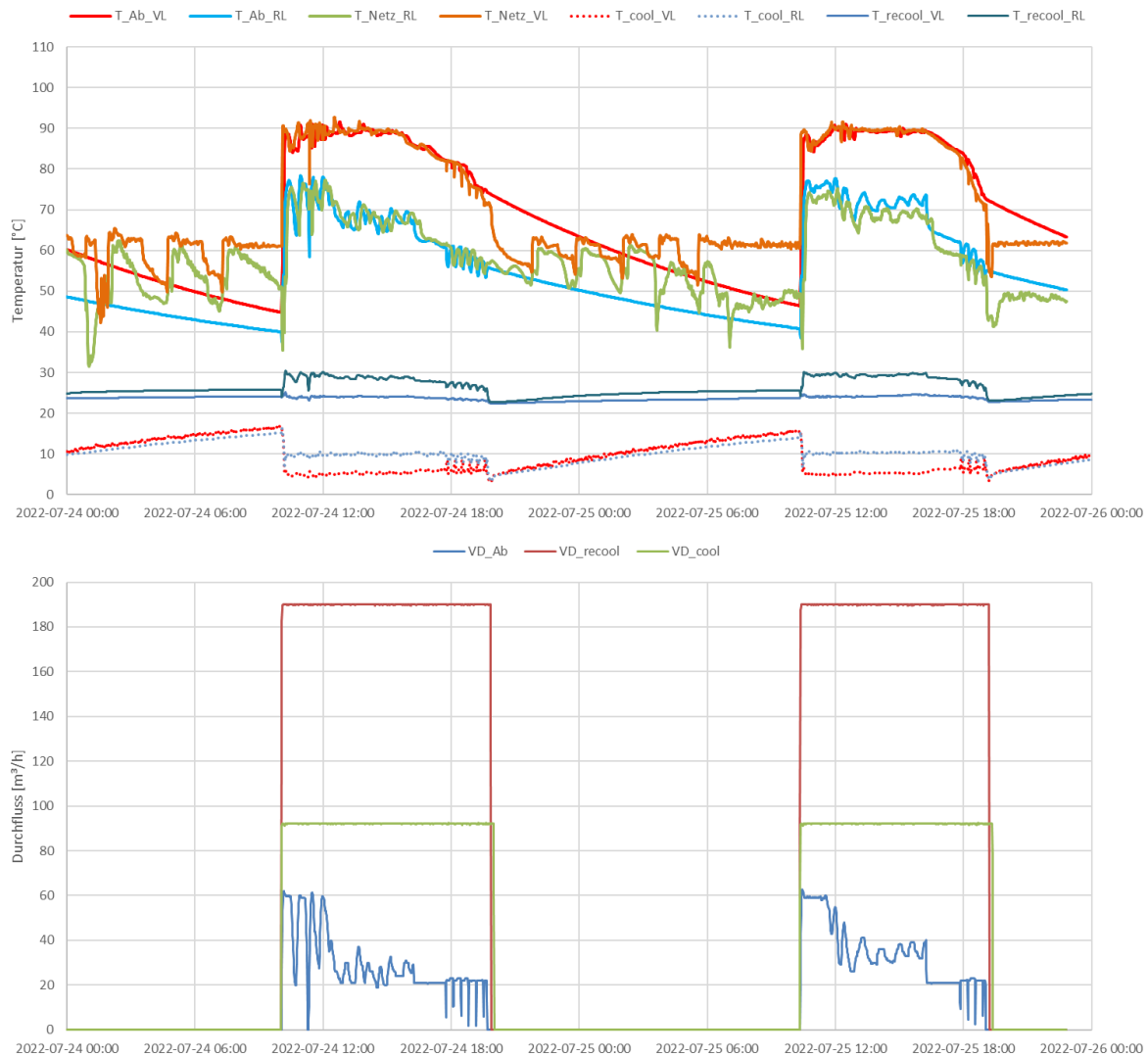
Abbildung 71: oben: Beispielhafter Verlauf der Temperaturen um die Absorptionskältemaschine des Verlaufs der Netztemperaturen; unten: Durchflüsse rund um die Absorptionskältemaschine an zwei Tagen im Juli (24.-25.7.2022)
