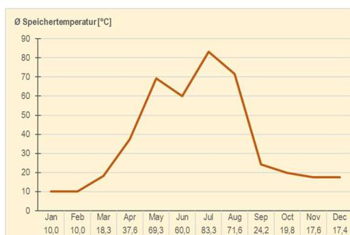
*Abbildung 10: Durchschnittliche Energiespeichertemperaturen*
