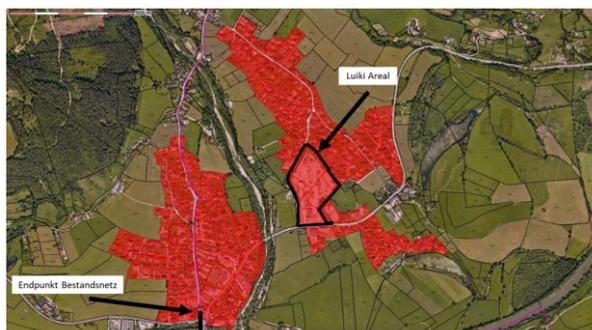
Abbildung 1: Abschätzung des Fernwärmepotentials im Ausbaubereich Hall Süd, Gesamt 4,9 MW potentielle Abnahmeleistung, Potentialgebiete Rot, (Quelle: ENVESTA)
