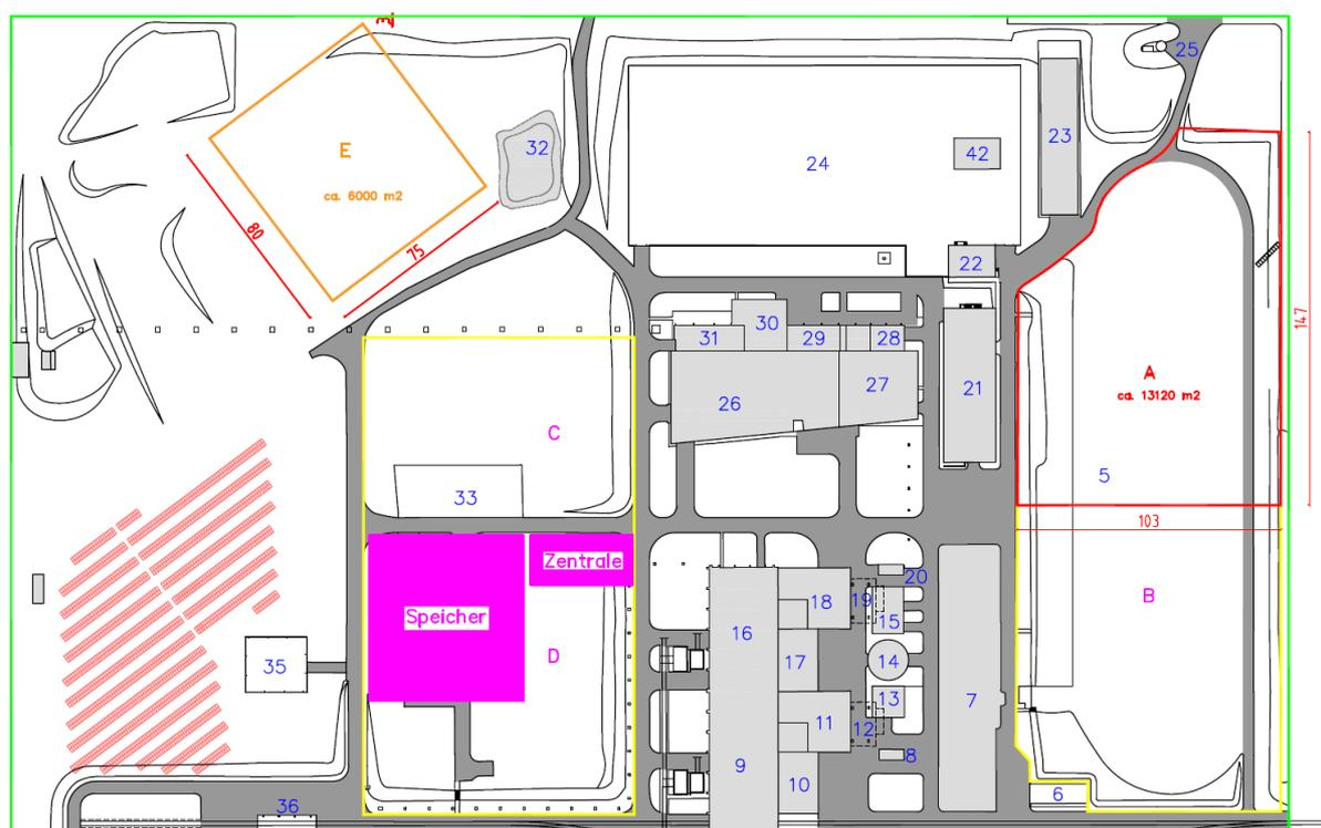
Abbildung 1: endgültige Freiflächen A + E für Solarthermie (rot + orange) und Geothermie (gelb)
