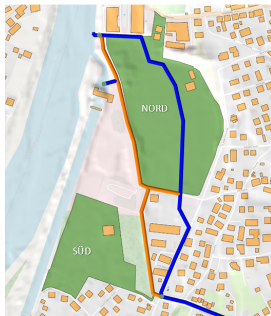
Abbildung 1: Schematische Darstellung des zu entwickelnden Areals. Dargestellt sind die beiden Entwicklungsgebiete Nord und Süd sowie das geplante Anergienetzes mit projektiertem Warmleiter (rot) und bestehendem Kaltleiter (blau). [Quelle: www.data.gv.at , www.osm.org , eigene Darstellung AEE INTEC.]
