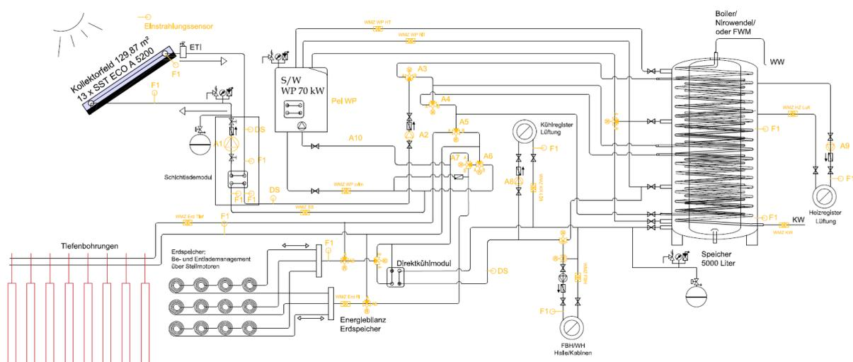
Der Innovationsgehalt liegt in der Regeneration des Erdreiches unter dem Gebäude durch Einspeisung der solaren Überschussenergie bei niedrigen Vorlauftemperaturen im Sommer. Dadurch bildet sich über mehrere Jahre ein „Wärmesee“ unter dem Gebäude aus, welcher als Solekreis für die Wärmepumpe dient und somit die Effizienz der Wärmepumpe und aufgrund des niedrigen Temperaturniveaus den Ertrag der thermischen Solaranlage erhöht.
