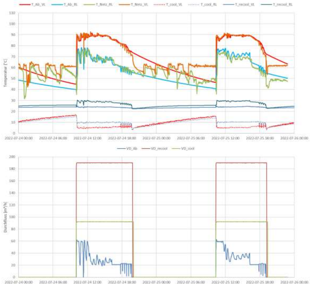
Abbildung 182: oben: Beispielhafter Verlauf der Temperaturen um die Absorptionskältemaschine des Verlaufs der Netztemperaturen; unten: Durchflüsse rund um die Absorptionskältemaschine an zwei Tagen im Juli (24.-25.7.2022)
