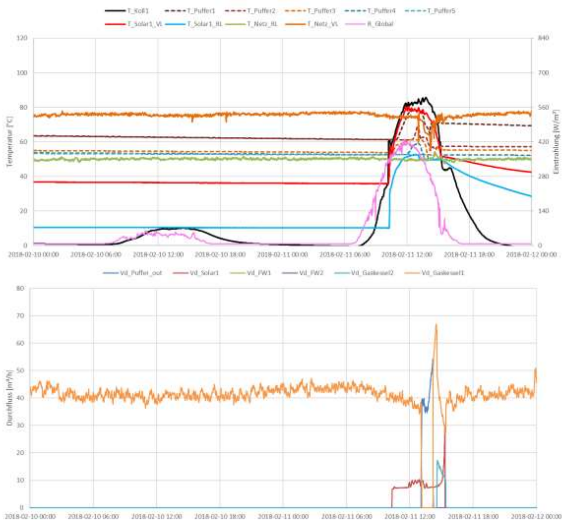
Abbildung 178: oben: Beispielhafter Verlauf von Temperaturen des Solarkreises, im Pufferspeicher und des Netzes zuzüglich des Verlaufs der Globalstrahlung unten: Durchflüsse sämtlicher Erzeuger sowie dem Netz an zwei Tagen im Februar (10.-11.2.2018)
