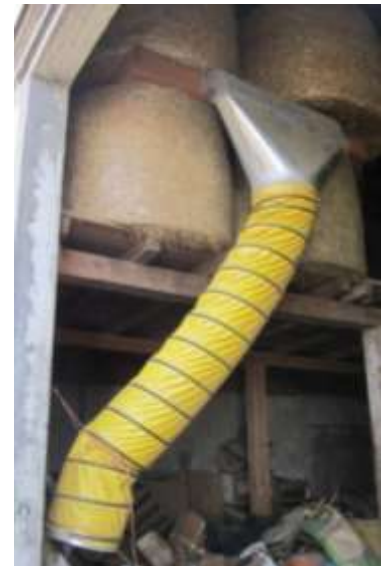
Abbildung 218: Luftverteiler für die Strohtrocknung. Quelle: AIT
