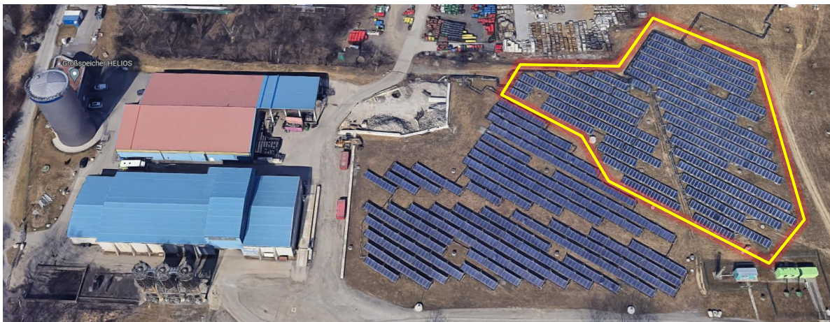
Abbildung 1: Bestehendes Kollektorfeld aus BA1 sowie das neu zugebaute Kollektorfeld aus BA2 (gelb markiert), am linken Bildrand ist der 2500 m 3 große Pufferspeicher abgebildet. (Quelle: maps.google.at )
