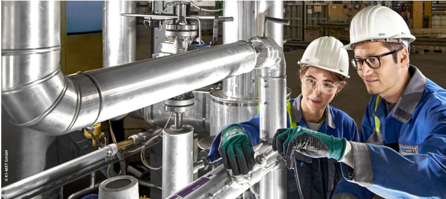
Nicole Weber und Nikolaus Rauch vom ZEUS-Projekt mit dem Aminwäscher zur CO 2 -Abscheidung.
