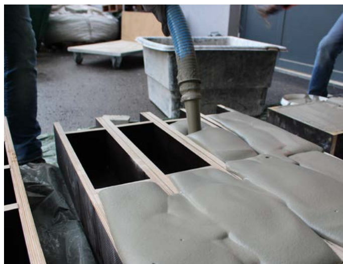
Erste Versuche mit neuartigen Betonformulierungen, die eine bessere Wärmedämmung bewirken, wurden bereits durchgeführt; Foto: Smart Minerals GmbH
