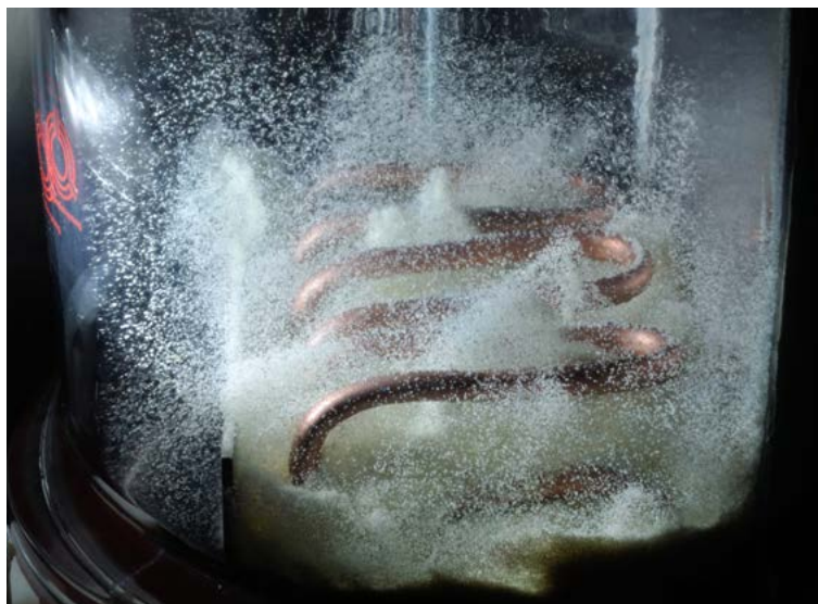
Wirbelschichtstufe des Adsorbers, Foto: TU Wien/Julius Pirklbauer
