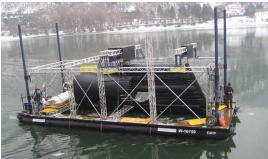
Die Strom-Boje ist ein schwimmendes Kleinkraftwerk für frei fließende Gewässer.
