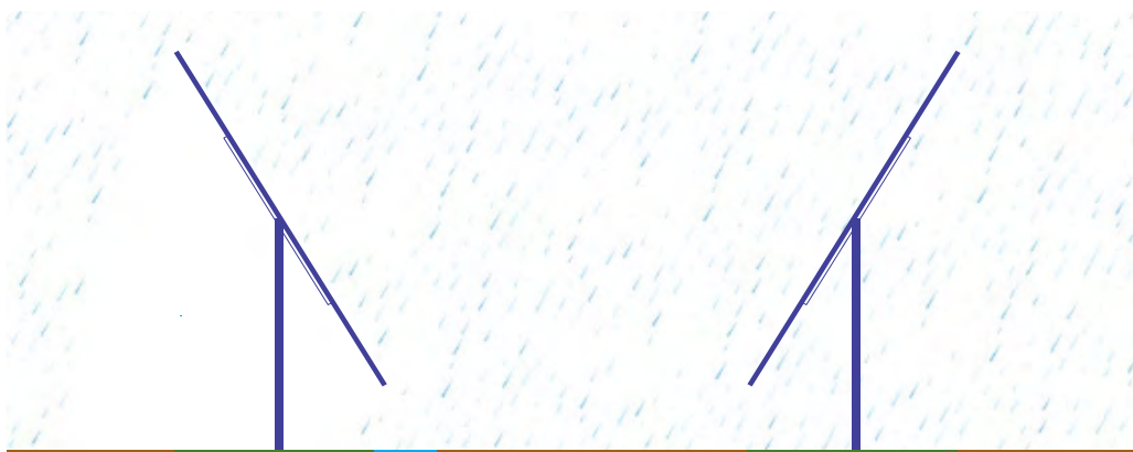
Abbildung 5: PV-Stellung dem Sonnenstand nachgeführt (links) und im Regenmodus (rechts).
