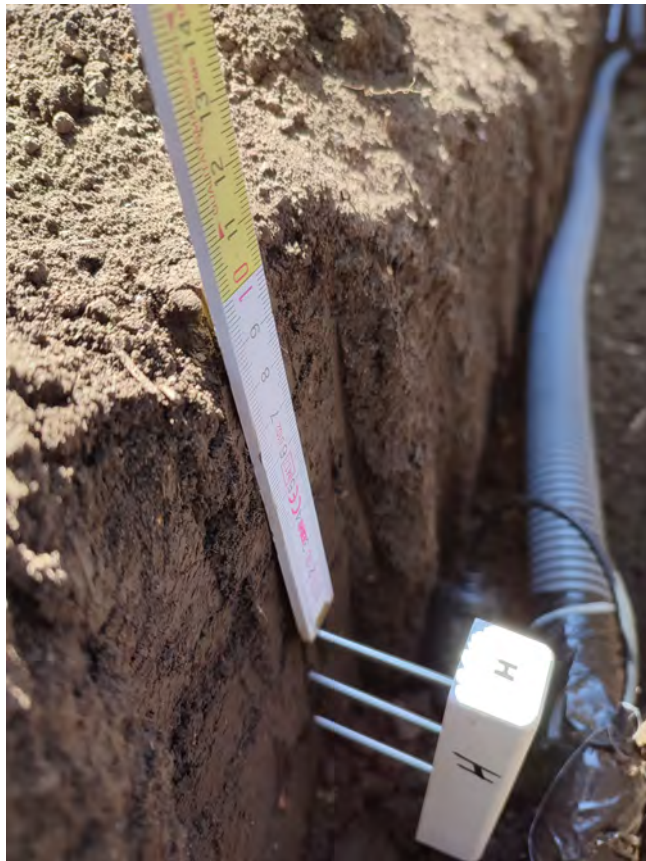
Abbildung 6: Installation Bodensensor Teros 12 in 10 cm Tiefe.
